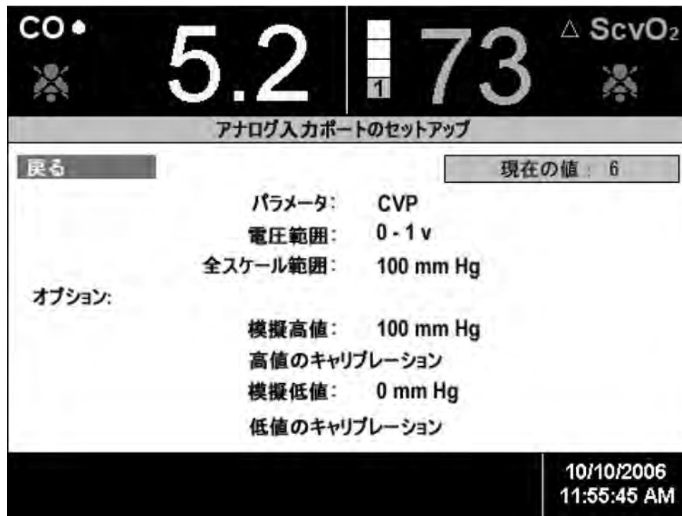
図 8-9 アナログ入力ポートのセットアップ画面
