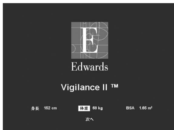
図6-4 患者データ画面 — 身長と体重に基づいて自動計算したBSA値
