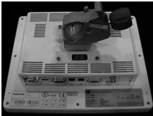
図 13-4 EV1000 モニターおよびモニター取付け金具
