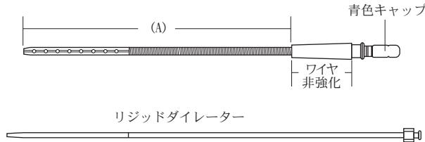
\* 付属のリジッドダイレーターは外径0.038インチ（0.96mm）のガイドワイヤに対応します。先端はX線不透過となっており、カニューレを位置決めする際の補助となります。
